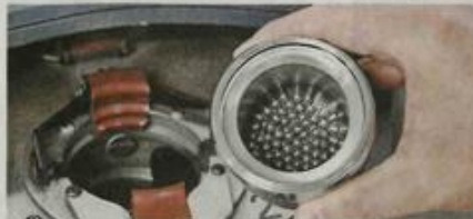
衝突エネルギーで水を分解して水素を生成する際に使用する鉄製ボールと研究室で現在使用する装置＝同大
